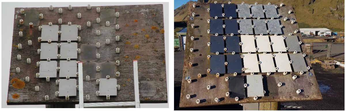
MYND 6 Uppsett sýni í tæringarrekkum á Höfn í Hornafirði (til vinstri) og í Vik í Mýrdal (til vinstri).
