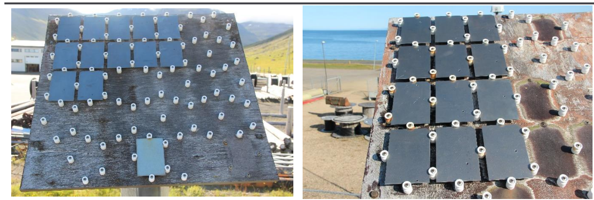
MYND 1 Uppsett sýni í tæringarrekkum í Bolungarvík (til vinstri) og Ólafsvík (til hægri).
