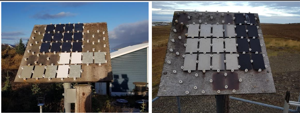
MYND 3 Uppsett sýni í tæringarökkum á Akureyri (til vinstri) og Þórshöfn (til hægri).
